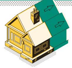
Une attention particulière doit être apportée à la **continuité de l'isolation de l'extension** avec celle du bâti existant. Par exemple, lors de l'isolation de combles habitables, l'isolant placé sous les rampants doit faire la jonction avec l'isolation des murs de la maison pour éviter un pont thermique. Si la maison n'est pas assez isolée, c'est le moment de prévoir une isolation complète.
